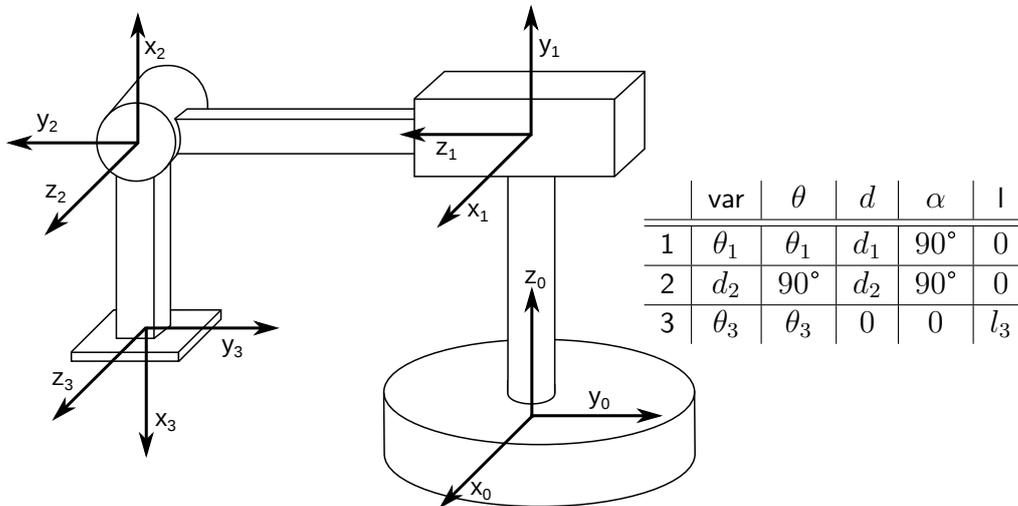
Die Geschwindigkeiten des Endeffektorframes können durch analytisches Ableiten der  ${}^R\mathbf{T}_H$ -Matrix nach der Zeit  $t$  berechnet werden. Dabei ist zu beachten, dass alle Gelenkvariablen selbst von der Zeit abhängen.
